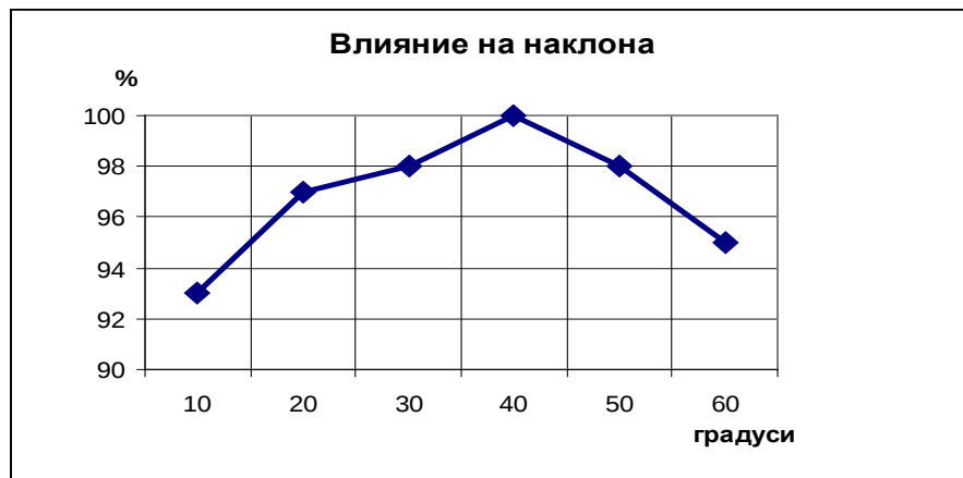
: Влияние на ъгъла на наклона върху количеството на приетата слънчева енергия
